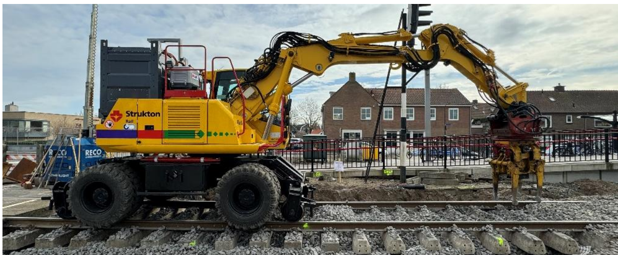
Figuur 5. Elektrische Krol bij spoorvernieuwingsproject
